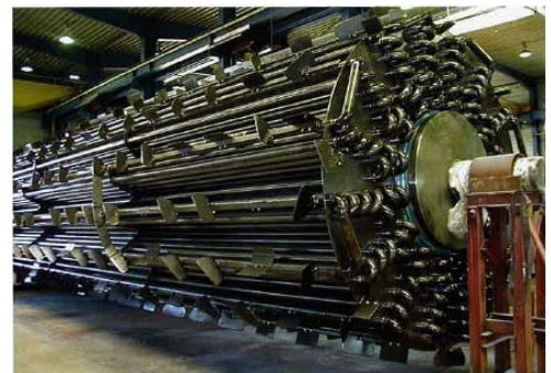
Рис. 11. Внутреннее устройство барабанной паровой сушилки (по материалам Fa.Buttner)
