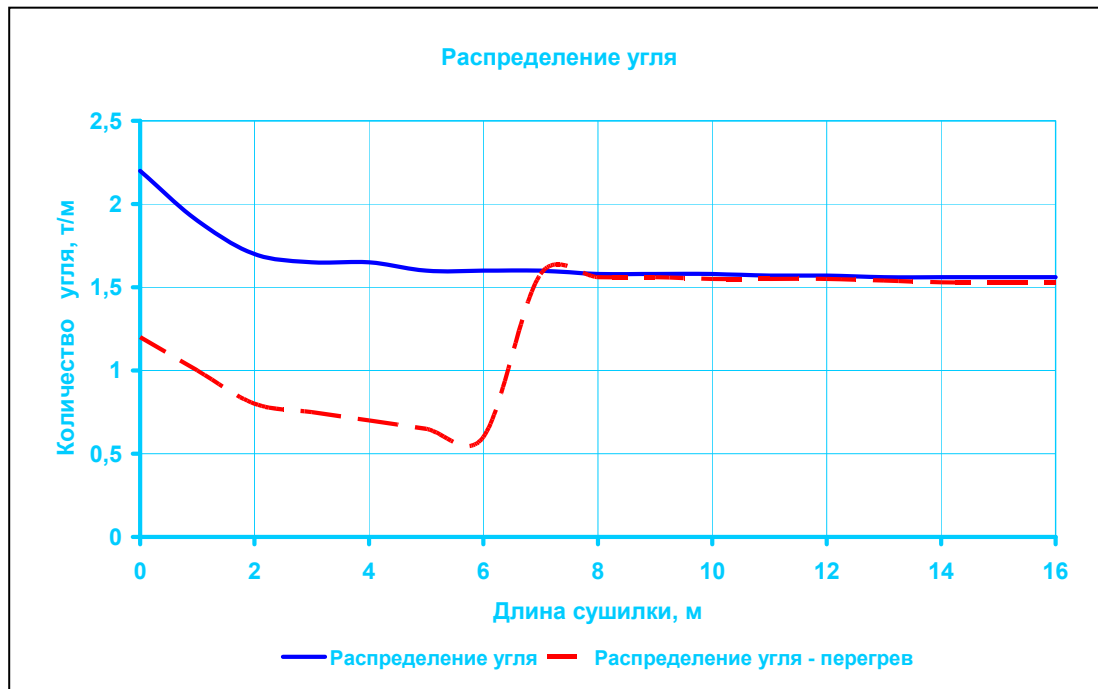
Рис 3. Распределение угля по длине сушильного барабана при равномерной загрузке и при снижении загрузки до 50% на время 5-10 минут.
