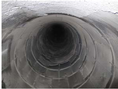
Рис.9. Против абразивная защита корпуса вертикальной трубной сушилки
