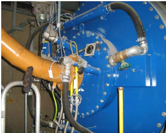
Рис.10. Генератор горячих газов работающий на угольной пыли.
