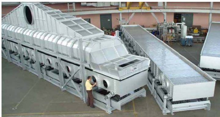
Рис. 6. Сушилка вибро-кипящего слоя (по материалам Fa. Binder)
